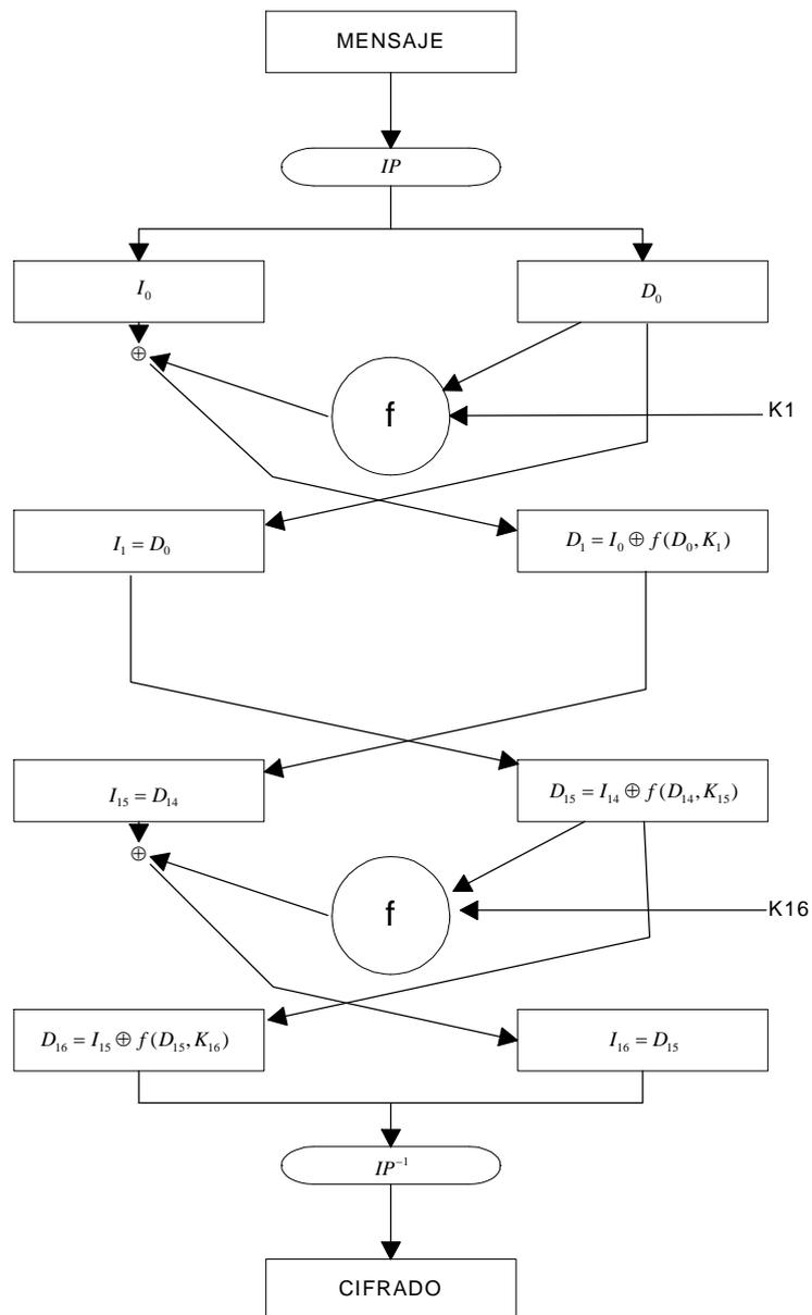
Los 64 bits del mensaje son sometidos a una permutación inicial y posteriormente el resultado es dividido en dos bloques de 32 bits que en el dibujo anterior hemos marcado como
