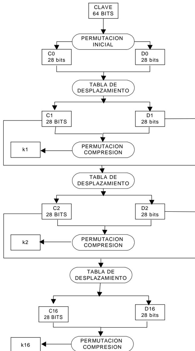
Se aplica a la clave una permutación inicial dada por la tabla KPI y posteriormente se divide en dos mitades que denominamos C y D a las que se le aplica un desplazamiento de bits marcado por la tabla de desplazamientos de clave KDC. Se vuelve a juntar la clave y se le aplica una permutación con compresión que viene dada por la tabla KPC, con lo que se consigue una nueva subclave de 48 bits.
