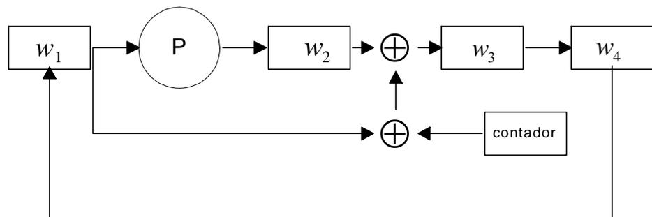
La permutación  $P$  es una estructura de tipo Feistel basada en una tabla de sustitución que denominamos  $F$  y que presentamos a continuación. La sustitución de un byte se realiza dividiendo el mismo en dos bloques de cuatro bits y utilizando los de la izquierda como fila y los de la derecha como columna.
